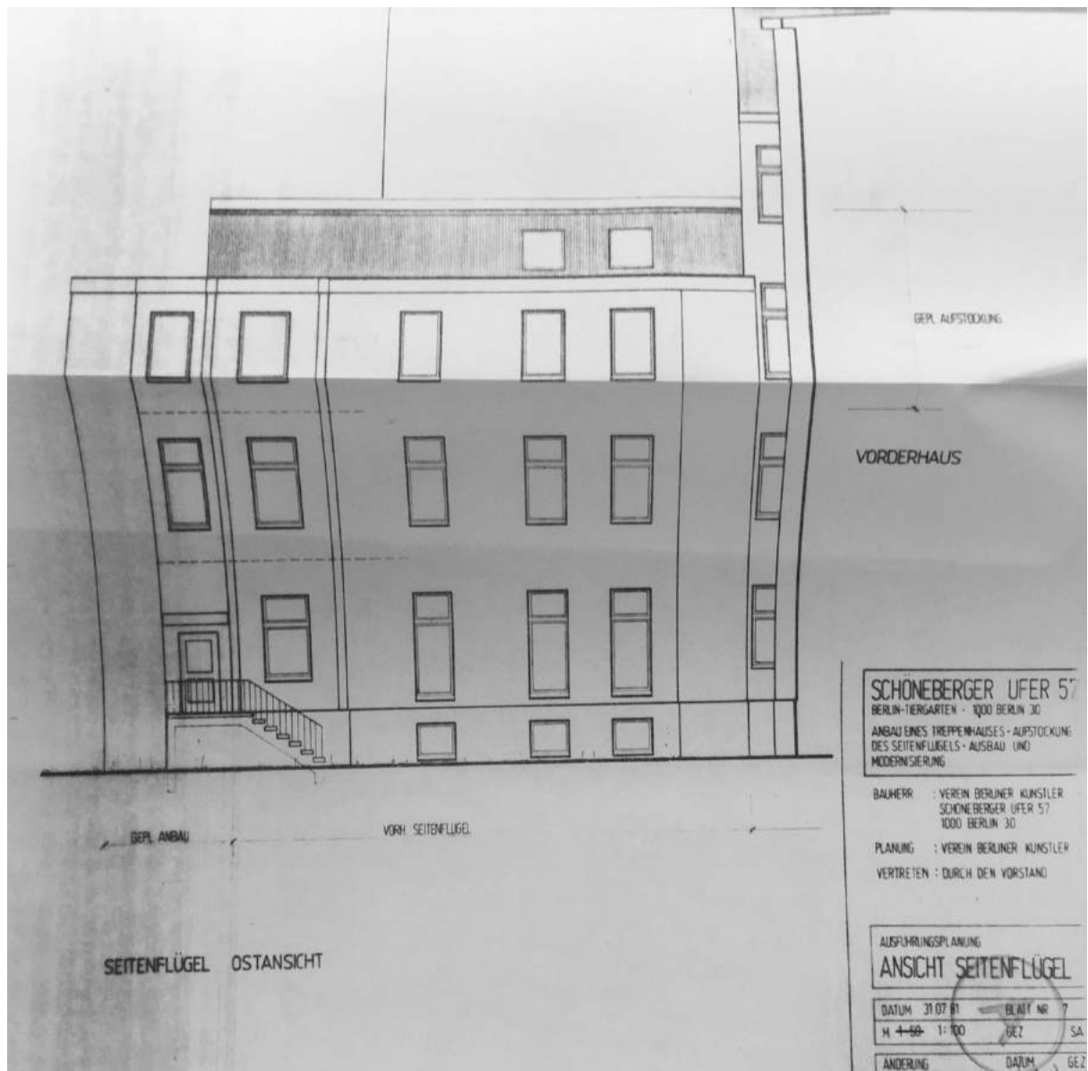
43) Plan zu einer einfachen Aufstockung des Seitenflügels, o.D. [um 1982] (BA Mitte, Bauaktenarchiv)
