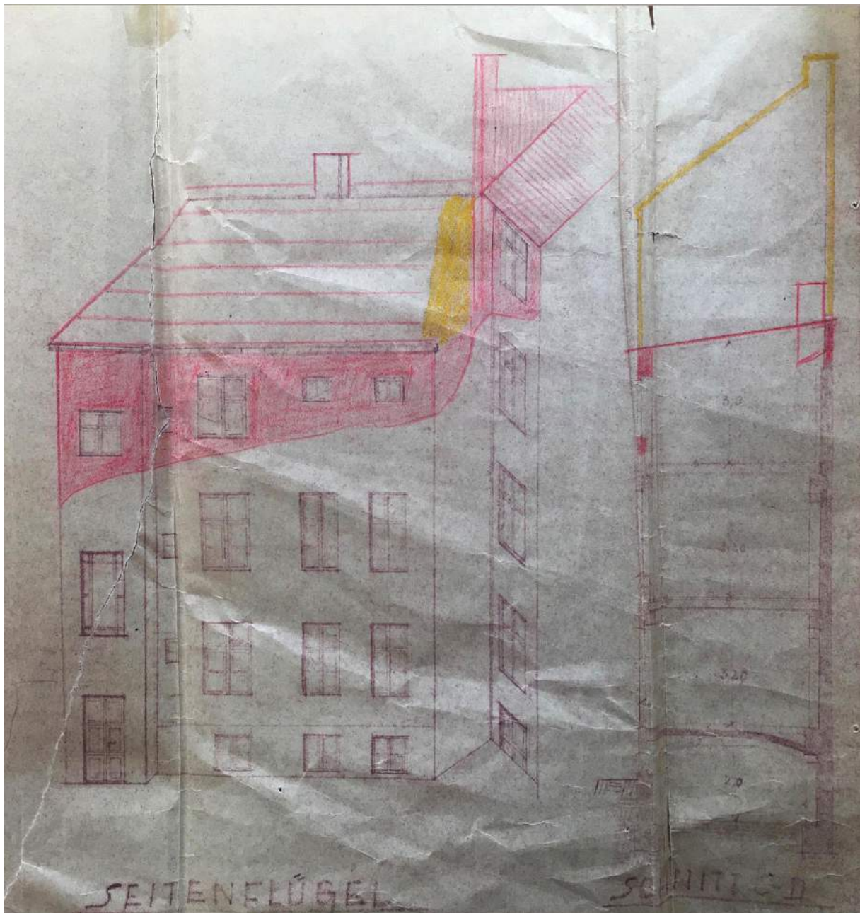
27) Ausschnitt des Seitenflügels aus der Bauaufnahme zum Schadensbericht der Fa. Kaiser & Pohl, 13. September 1949 (BA Mitte, Bauaktenarchiv)
